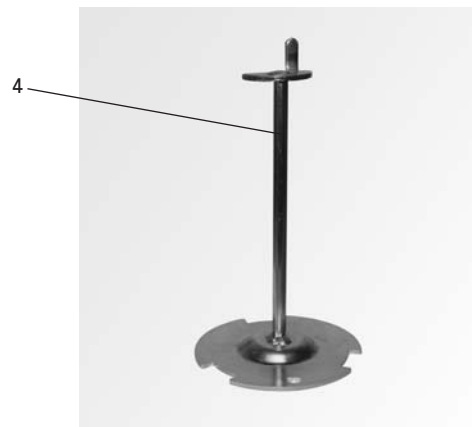
Abb. 121 Werkzeug für Konus- und Rost-Entnahme
