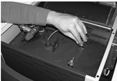
Abb. 143 Flügelmuttern und Deckel entfernen
