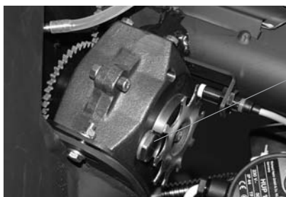
Abb. 151 Zellradschleuse Staub entfernen
