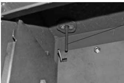
Abb. 127 Thermocontrol-Fühler reinigen (mit Reinigungspinsel)
