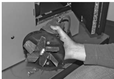
Abb. 155 Gebläse- und Abgasrohr reinigen
